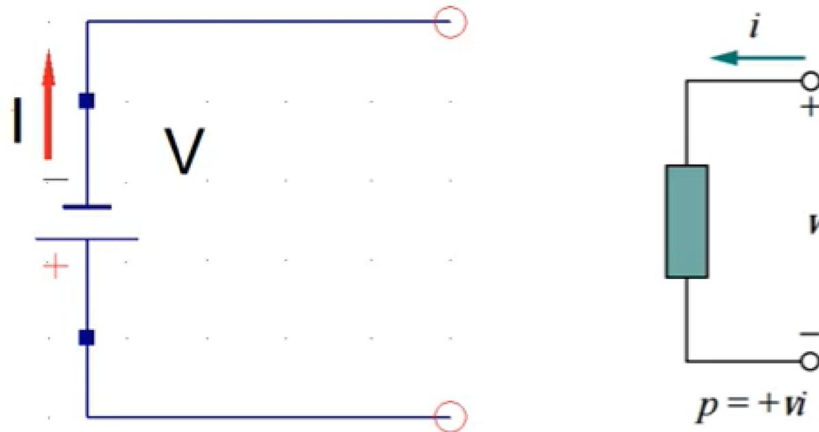
Fig. 4 - Convenção de sinal de um elemento passivo
