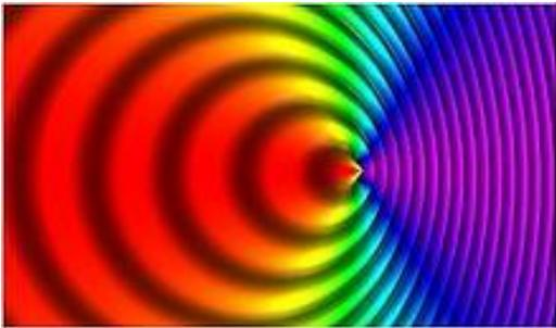
Fonte se deslocando para a direita com velocidade  $v = 0,7c$
