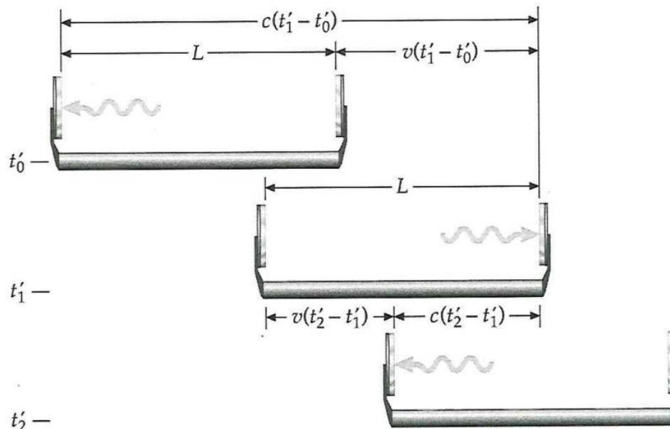
No SRP (Sistema de Referência Próprio) o comprimento do relógio de luz é  $L_0$  e o tempo entre marcas (quando a luz bate nos espelhos) é  $T_0 = \frac{2L_0}{c}$
